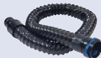
Tuyau respiratoire 3M™ Versaflo™ BT-20 S / L Tuyau respiratoire léger, facile à nettoyer, disponible en 2 longueurs Matériau : polyuréthane Longueur : 735 mm (S), 965 mm (L)
