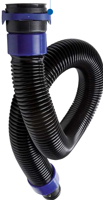
Tuyau respiratoire 3M™ Versaflo™ BT-20 S / L Tuyau respiratoire léger, facile à nettoyer, disponible en 2 longueurs Matériau : polyuréthane Longueur : 735 mm (S), 965 mm (L)
