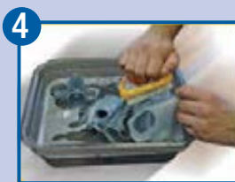
4 Mettez les pièces dans une solution détergente chaude (la température ne doit pas excéder 50°C). Frottez avec une brosse.
