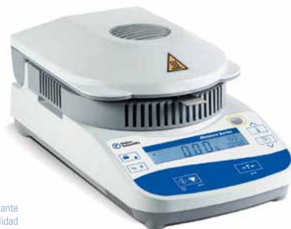
El analizador de humedad de Fisherbrand es de construcción resistente, de alta calidad y fácil configuración mediante un botón. Con una pantalla LCD retroiluminada grande, un puerto RS232 estándar, capacidad de 60g con una legibilidad de 0,005g/0,05% y calefacción halógena, resulta idóneo para análisis de alimentos, control de calidad, análisis de agua residual y un gran número de aplicaciones industriales, medioambientales y de ciencias de la vida.
