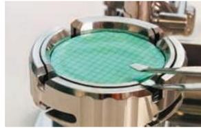
(C) Einfaches Entfernen der Membran.
