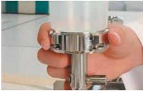
(A) Eine spezielle Verschluss-technik sorgt für eine gute Abdichtung von Trichter und Membran und reduziert Kreuzkontamination auf ein Minimum.
