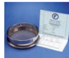
Fabricado con acero inoxidable y disponible en una amplia variedad de tamaños. El tamiz de ensayo de acero inoxidable Fisherbrand™ con malla de alambre tejido tiene un diámetro de 200 mm.
