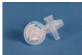
Diseñado para el análisis de rutina diario. El filtro de jeringa de PTFE no estéril Fisherbrand™ incluye una membrana de PTFE hidrófoba para la filtración de soluciones orgánicas para HPLC. Disponible en dos diámetros de membrana (13 y 25 mm) y dos tamaños de poro (0,2 y 0,45 µm).
