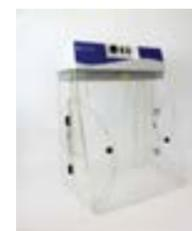
Limita la contaminación de la reacción de PCR. La cabina de esterilización de UV Fisherbrand™ con temporizador proporciona una zona cómoda para preparar reacciones de PCR en un entorno libre de ácidos nucleicos.
