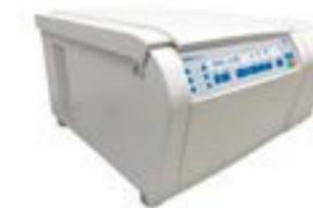
La centrifuga de sobremesa Fisherbrand™ GT2 de tamaño medio proporciona velocidad y versatilidad, alcanzando 4238 x g para separaciones rápidas y eficaces
