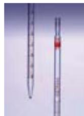
Pipeteo líquidos con precisión. Las pipetas graduadas de clase AS y tipo 1 Fisherbrand™ se han fabricado con vidrio sodocálcico. Las pipetas de tipo 1 tienen la marca de cero en la parte superior.
