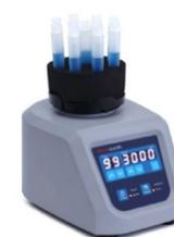
Mélange précis et efficace des échantillons. Conçus pour un contrôle précis de la vitesse afin de mélanger ou battre les échantillons en continu.
