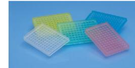
Directement compatibles avec tous les principaux thermocycleurs, notamment les instruments ABI—peuvent être utilisés dans les séquenceurs à 96 puits ABI sans adaptateurs.
