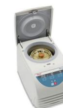
Centrifugez 24 x 2 ml à une vitesse atteignant 21,100 xg avec réfrigération pour accélérer la préparation de routine des microtubes à centrifuger.
