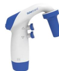
Un pipeteur puissant, léger et ergonomique, compatible avec toutes les pipettes en verre ou en plastique couramment utilisées.
