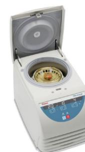
Centrifugez 24 x 2 ml à une vitesse atteignant 21,100 xg avec réfrigération pour accélérer la préparation de routine des microtubes à centrifuger.
