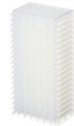
Assurez-vous une récupération complète des échantillons grâce aux plaques en polypropylène à 96 puits Thermo Scientific Nunc MicroWell. Ces plaques sont idéales pour le stockage, car le polypropylène offre une capacité de liaison inférieure empêchant les protéines ou l'ADN de se lier. Le polypropylène supporte des températures allant de -80 °C à +121 °C. Disponible en différentes couleurs pour identifier rapidement les plaques de stockage.
