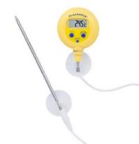
Les thermomètres numériques faciles à lire sont compacts à tenir dans votre main ou à monter sur un mur dans des zones restreintes.
