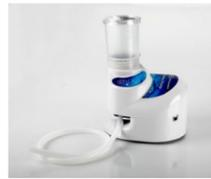
La pompe Sentino remplace les systèmes traditionnels de filtration sous vide pour la filtration sur membrane par une petite pompe à action péristaltique et un circuit de passage de liquide stérile à usage unique.
