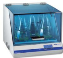
L'agitateur incubateur Fisherbrand avec plateforme à tapis est un agitateur incubateur pour flacons et tubes.
