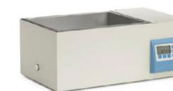
Prend en charge vos tests de coliformes fécaux grâce aux bains-marie pour coliformes, conçus spécifiquement pour cette application. Les bains-marie sont pré-réglés à des températures optimales pour une utilisation simple.
