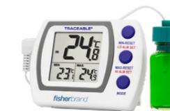
Fournit des mesures précises lorsque la porte du réfrigérateur / congélateur est ouverte grâce à une sonde scellée dans un flacon rempli d'une solution de glycol qui isole le capteur.
