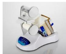
Le distributeur Sentino permet une distribution aseptique des filtres à membrane individuels avec une seule pression sur son clavier tactile.
