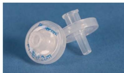
Conçu pour les analyses de routine quotidiennes. Le filtre pour seringue en PTFE non stérile Fisherbrand est équipé d'une membrane en PTFE hydrophobe pour la filtration des solutions HPLC aqueuses et organiques. Deux diamètres de membrane (13 et 25 mm) et deux tailles de pores (0.2 et 0.45 µm) sont disponibles.
