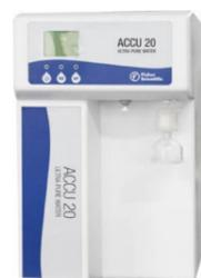
Fisherbrand Système de production d'eau ultra-pure Accu20 utilisé pour produire de l'eau ultrapure de type I et de l'eau RO à la demande directement à partir de l'eau du robinet.
