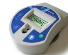
Instrument robuste et facile à utiliser dédié à la mesure de la densité des cellules en suspension, telles que *E. coli*, levures, cellules et autres cultures cellulaires.
