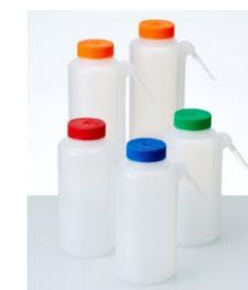
La pissette ronde intégrale Azlon est moulée avec un bec verseur intégré pour réduire la contamination provoquée par le tube interne touchant le plateau de paille pendant le remplissage.
