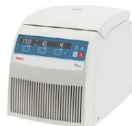
Idéale pour un usage quotidien en laboratoire, elle permet de réfrigérer et de centrifuger jusqu'à 24 microtubes à centrifuger par cycle.
