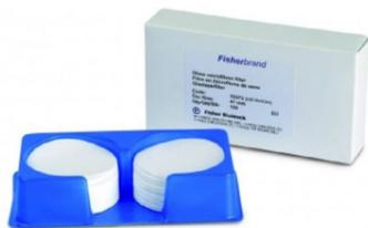
100 % microfibre de verre borosilicaté. Les filtres en microfibre de verre Fisherbrand de grade 259 sont non hygroscopiques et biologiquement inertes. Ils font preuve d'une résistance chimique à la plupart des solvants et des réactifs (à l'exception de l'acide fluorhydrique).
