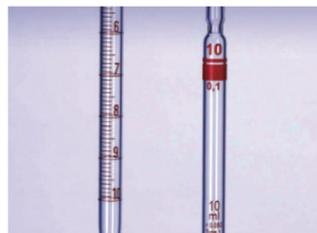
Pipetez les liquides avec précision. Les pipettes Fisherbrand graduées de classe AS et de type 1 sont fabriquées en verre sodocalcique. La marque zéro se trouve en haut des pipettes de type 1.
