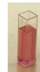
Utilisez ces cuves pour obtenir des températures d'échantillon plus stables pendant les mesures photométriques. Les macro cuves en PS pour longueurs d'ondes visibles Fisherbrand™ offrent une excellente portée de transmission optique et une faible épaisseur de paroi pour un transfert de chaleur accru.
